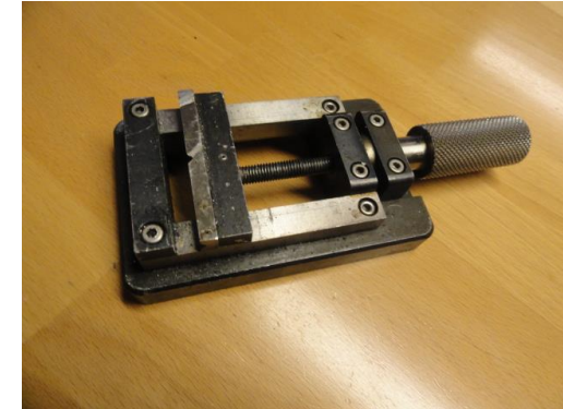
Flacher Schraubstock Für Stecker etc geeignet
